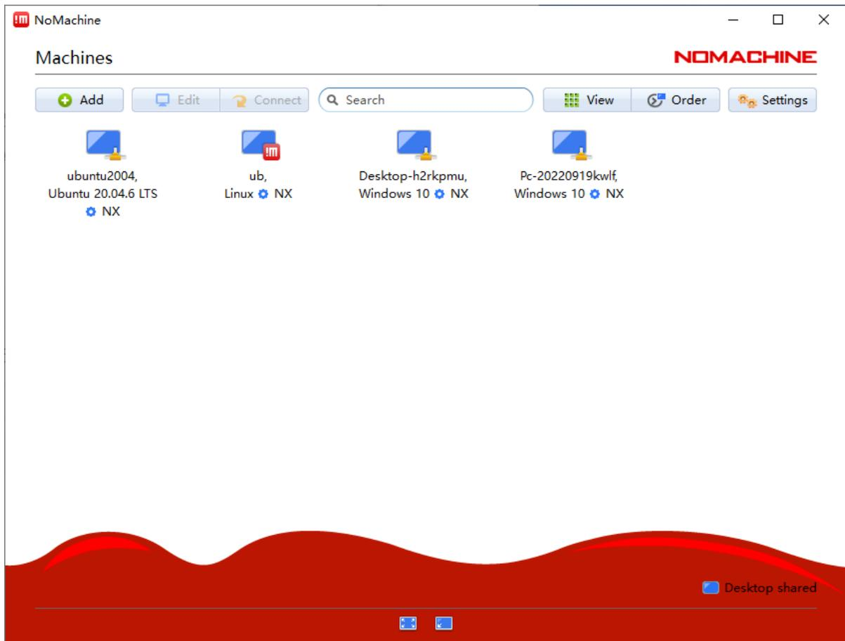
会看到如上界面，通常情况下，开发板和 PC 端在同一网段时，软件会自动扫描到安装了 NoMachine 的系统，如上图第一个。如果没有，需要获得开发板的 IP 地址，在软件中点击  添加。
